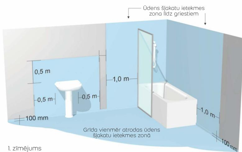
Ko tas nozīmē no hidroizolācijas viedokļa? Saskaņā ar Weber prasībām, neatkarīgi no paredzamā ūdens apjoma hidroizolācija visā telpā tiek veikta divās kārtās (t.i., visas sienas un grīda). Svarīgi ievērot hidroizolācijas ieklāšanai noteikto patēriņa normu uz 1 m<sup>2</sup>, kas nodrošina pietiekamu slāņa biezumu (orientējošs slāņa biezums pēc nožūšanas ir 0,5 mm). Saistībā ar paaugstinātu risku kontroles mērījumus vēlams veikt zilajās zonās.
