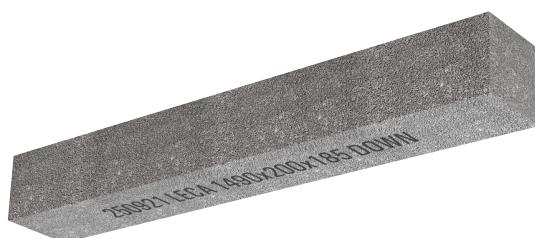
Lai būvuzraugiem objektos būtu vieglāk identificēt pārsedžu izmēru un pareizu uzstādīšanu, Fibo pārsedzēm uz malas ir uzdrukāts izgatavošanas datums, ražotājs, izmērs un pareizais novietojama stāvoklis. Pārsedzi obligāti jāuzstāda ar apdrukāto malu uz leju, uzstādīšana citā virzienā ir kategoriski aizliegta!
